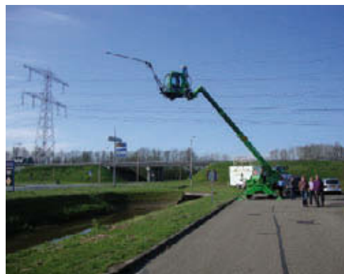
De "bugbuster" een nieuwe ontwikkeling: een zuigunit op hoogwerker met cabine (foto: Arnold van der Staak, gemeente Enschede)
